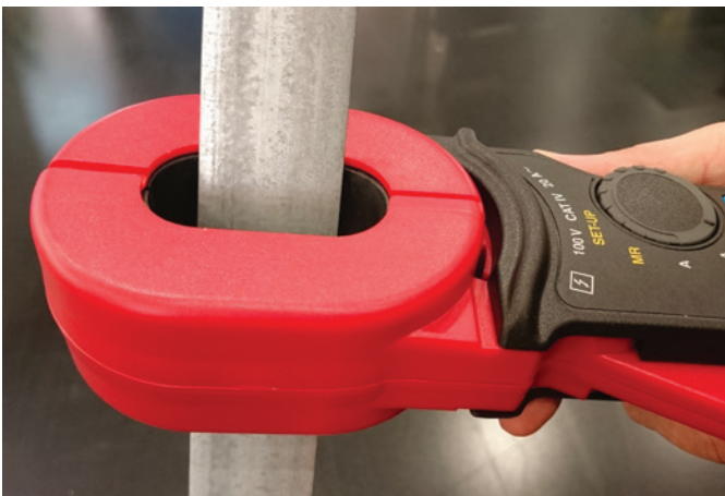
Messung an Banderder mit CA 6418 dank länglichem Messkopf
