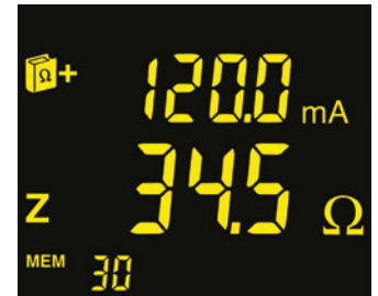
1. Anzeige: Impedanz und Ableitstrom
